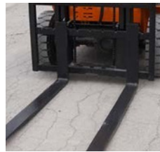
Horquilla delantera forjada de mayor espesor
