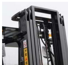
Cerco de puerta reforzado
